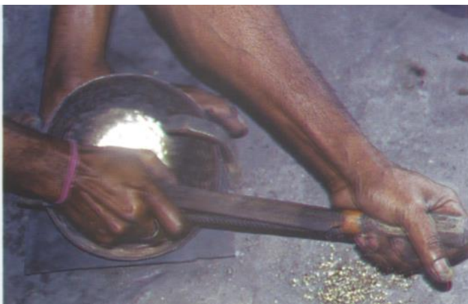
Abb. 7: Traditionelles Polieren der Klangschalen per Hand (Hess/Zurek, 2005, S.97)
