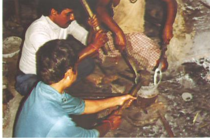
Abb. 6: Erhitzung des Metalltalers und Austreiben im Gruppenprozess (Hess/Zurek, 2005, S.97)
