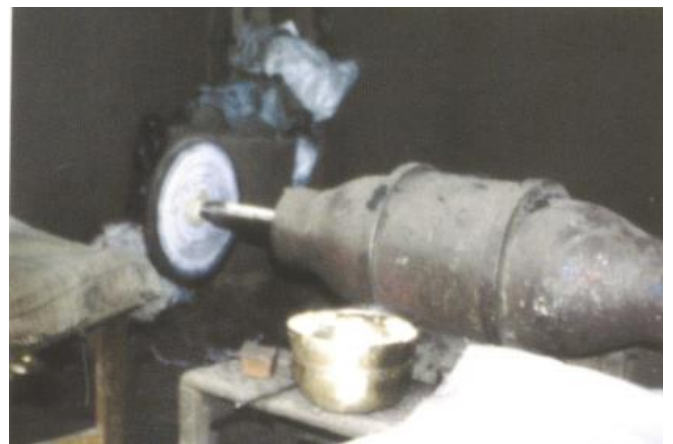
Abb. 8: Modernes Polieren der Klangschalen mit Hilfe von Maschinen (Lindner, 2008, S.12)
