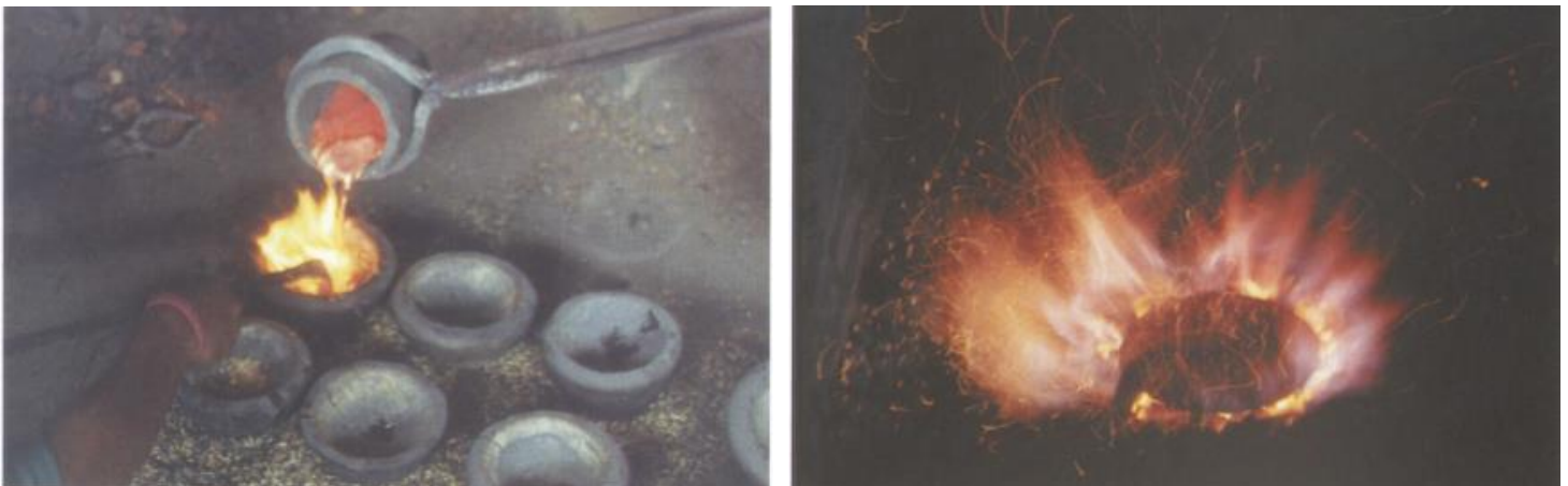
Abb. 4: Eingießen der Metalllegierung in Formen (links), Erhitzen der Legierung (rechts) (Hess/Zurek, 2005, S.96)
